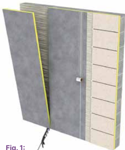
Fig. 1: Pose de panneaux de construction à carrelé.
